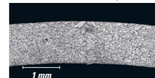
fischer setzt auf Laserschweißen mit Schweißnahtfaktor V = 1,0
